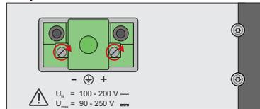
Abb.: Schraubverriegelung von MSTB-Steckern am Beispiel eines LANTIME M320
