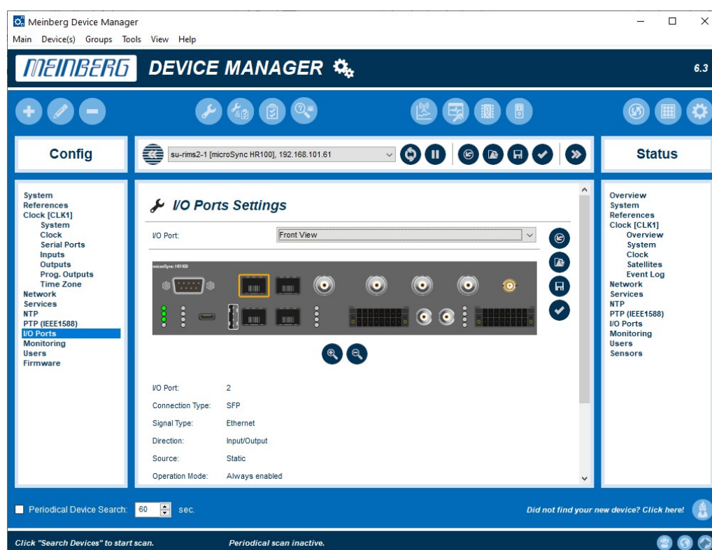
Abbildung: Meinberg Device Manager – Ein- und Ausgänge bei einem microSync HR System
