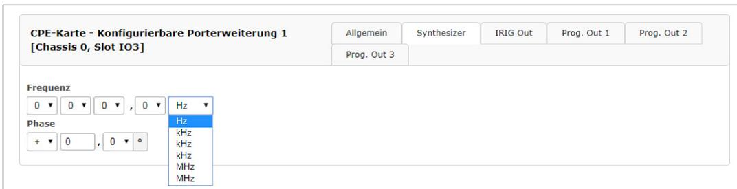
Abb.: Menü - Reiter „Synthesizer“ Frequenz für die Auswahl Frequency Synthesizer im Menü „Prog. Out“
