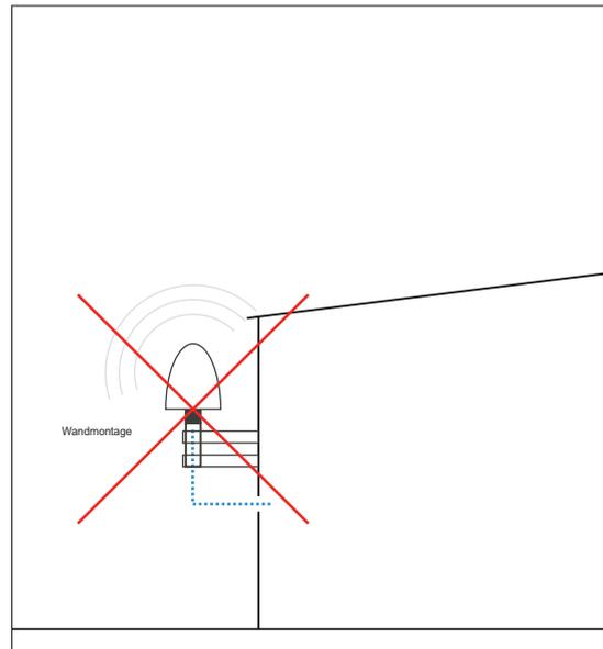
Abb. 2: Nicht empfohlene Positionierung einer wandmontierten Antenne
