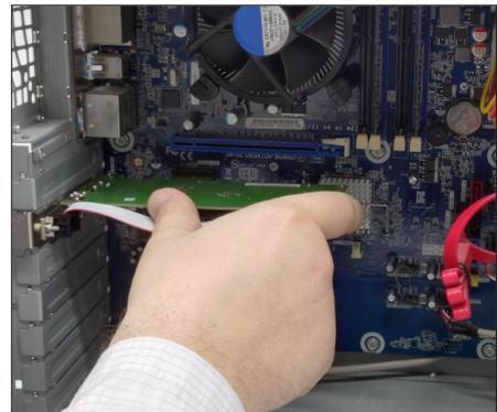
3. Sichern Sie die Karte fest am Gehäuse mit einer geeigneten Befestigungsschraube und montieren Sie dann das Gehäuse wieder zusammen.
